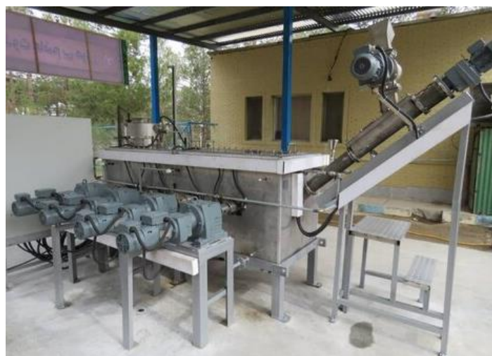
شکل ۱: پایلوت هاضم بی‌هوازی بخش آلی زباله‌های جامد شهر اصفهان، مستقر در کارخانه پردازش پسماند اصفهان
