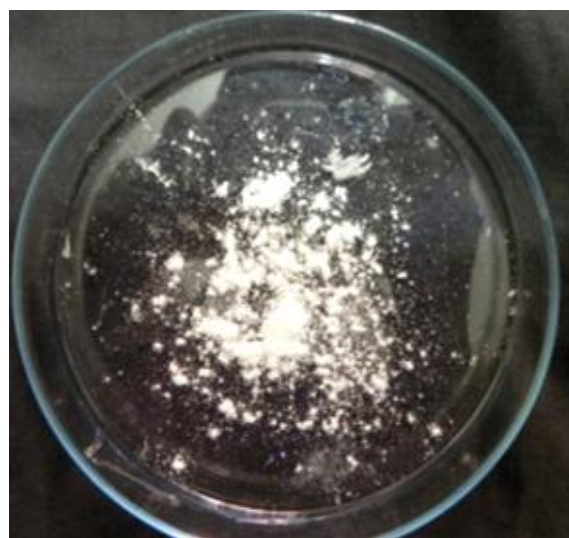
شکل ۶- نمونه پلی‌هیدروکسی‌بوتیرات خالص شده: پلی‌مر به شکل پودر سفید رنگی به دست آمد.
