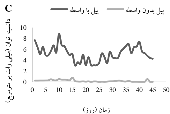
شکل ۱- مقایسه عملکرد الکتروشیمیایی پیل سوختی میکروبی رسوبی در حضور و نبود واسطه؛ A. نمودار ولتاژ، B. نمودار دانسیته جریان، C. نمودار دانسیته توان، D. نمودار پولاریزاسیون
