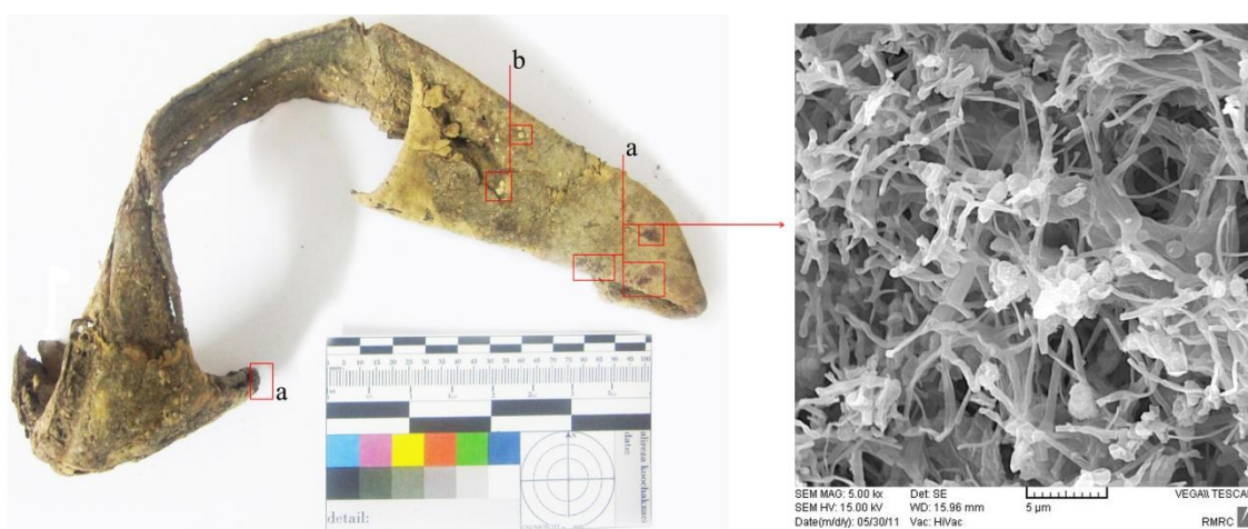
شکل ۱- چپ: بقایای لنگه کفشی چرمی (SH2 Tri)؛ a: کلونی‌های سفید تشکیل شده بر روی سطح چرم مربوط به قارچ تریکوفیتون؛ b: لکه‌های قرمز ایجاد شده توسط فعالیت قارچ؛ راست: شکل ۱۵ SEM از مقطع عرضی لکه‌های قرمز با بزرگنمایی ۵۰۰۰ برابر که نشان‌دهنده نفوذ قارچ به لایه‌های زیرین چرم و تخریب شدید الیاف کلاژن است که به شکل کاهش استحکام و پودری شدن الیاف سطحی چرم دیده می‌شود (آرشیو نگارنده)
